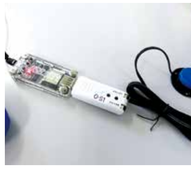
写真3 スイッチ接続キット。これでiPadとスイッチを接続します
