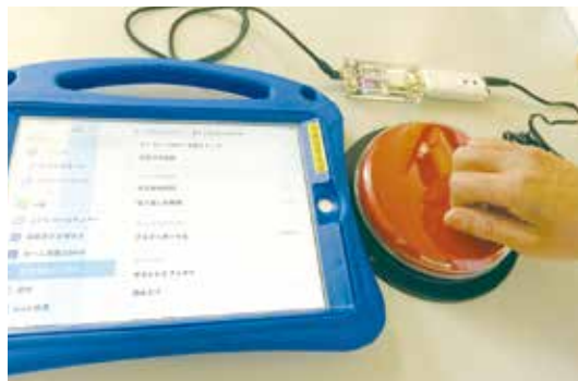
写真2 上面を押して操作するスイッチ。
