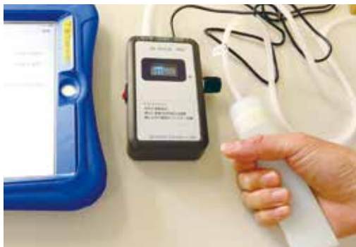
写真1 空気圧の変化に反応する圧力センサスイッチ。弱い力にも反応します
